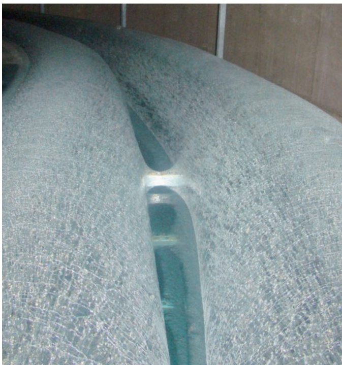
1 Gefriervorgang: Beim Übergang von Wasser zu Eis entsteht Kristallisationswärme – und damit viel Energie.
